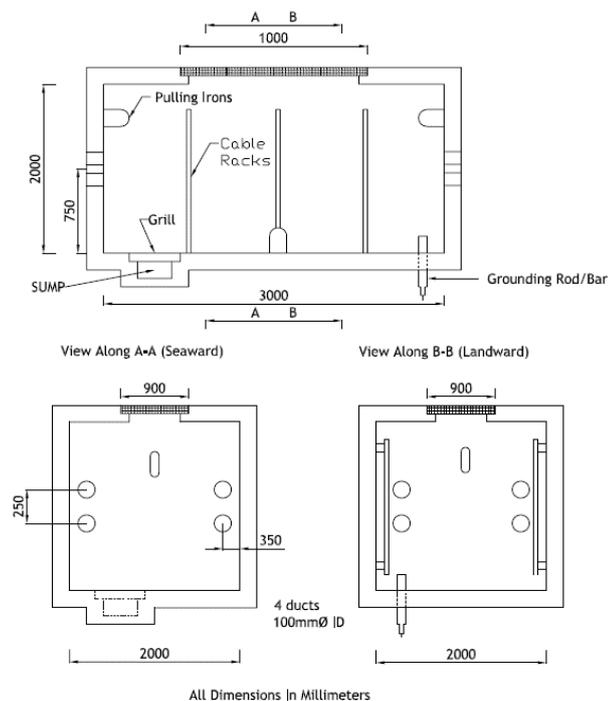
Figure 6 : Différentes vues en coupe d'une chambre-plage (Orange)
